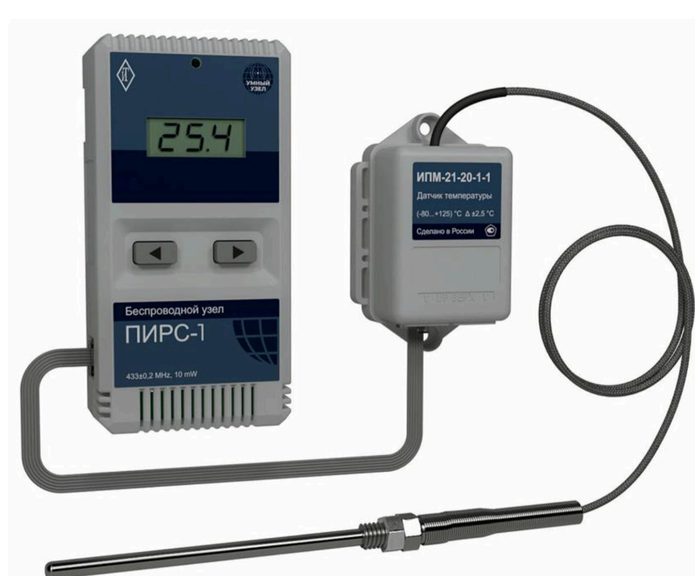
Узел «ПИРС-1» с подключенным датчиком криогенной температуры «ИПМ-21-21-11»
