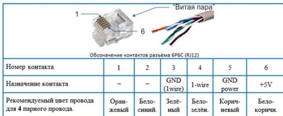
Рисунок 2 – Обозначение контактов разъема «6P6C»
