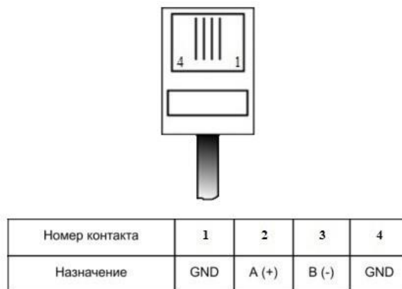
Рисунок 1б – Обозначение контактов разъема RS485
