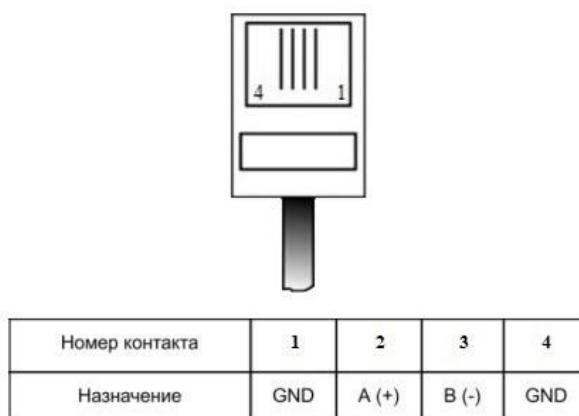
Рисунок 4 - Обозначение контактов для подключения к разъему RS485.
