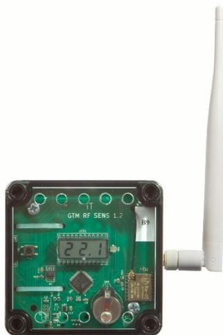
Рисунок 5 – общий вид узла беспроводного «E-Sens»
