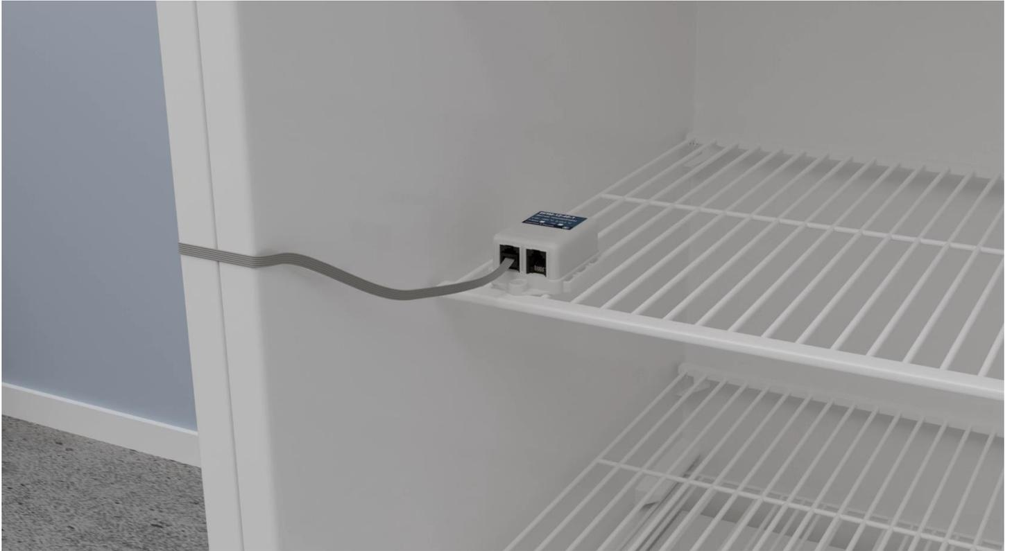
Рис. 9 Применение Берег-РП в аптечном складе. Размещение датчика температуры в фармацевтическом холодильнике
