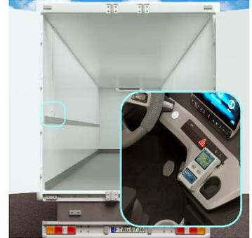
Рис. 4 Пример применения Берег-РП для мониторинга температуры внутри авторефрижератора (прибор в кабине)
