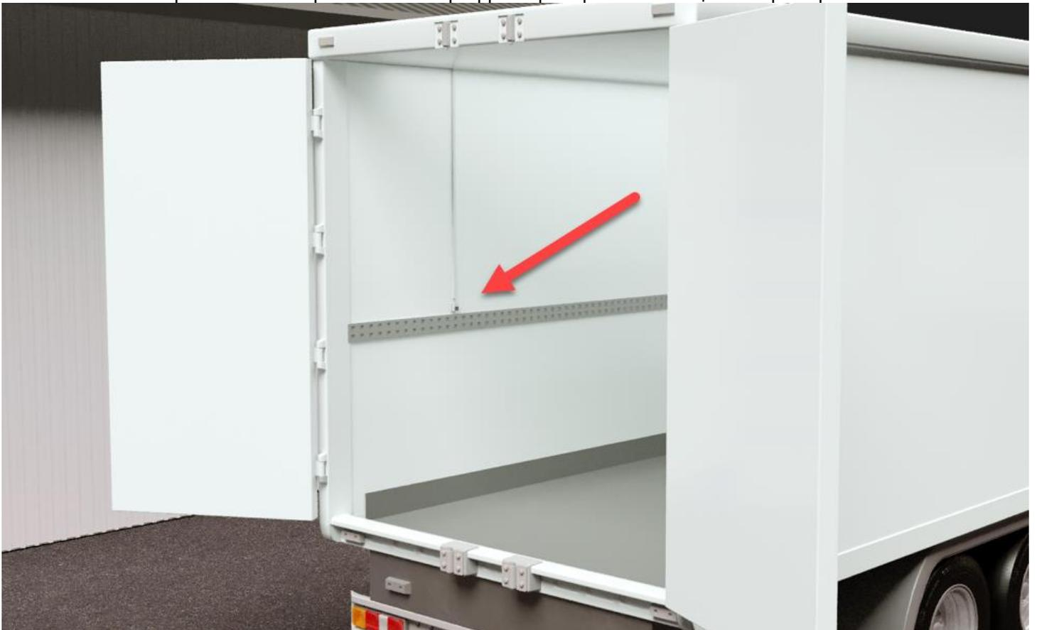
Рис. 6 Применение Берег-РП в авторефрижераторах. Размещение датчиков в кузове
