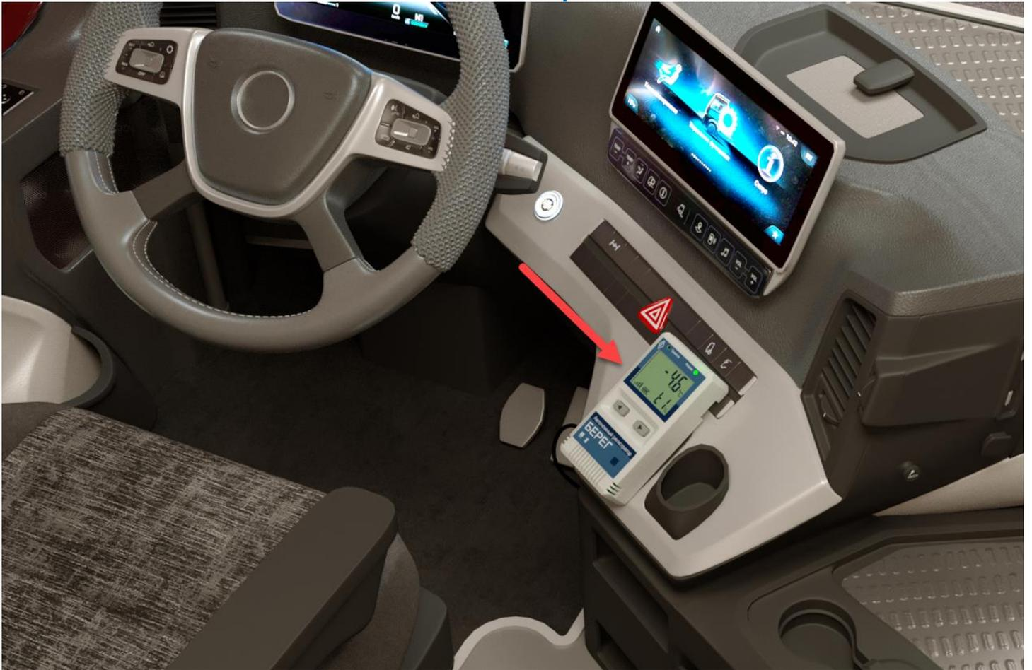
Рис. 5 Применение Берег-РП в авторефрижераторах. Размещение прибора в кабине
